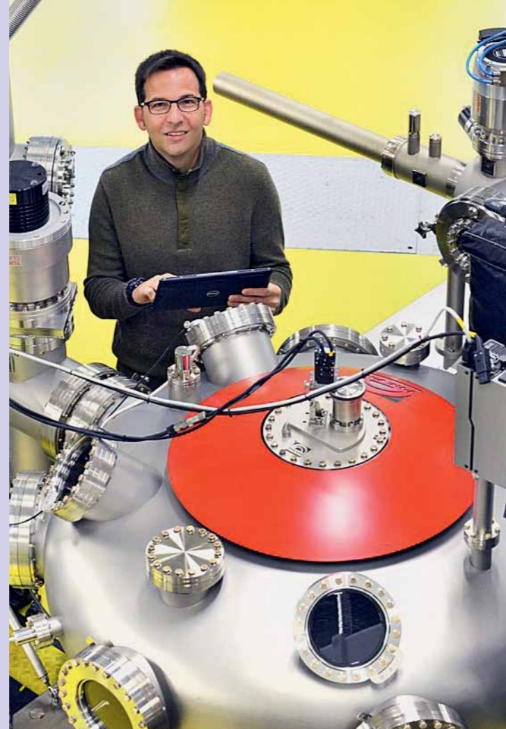
Strukturen besser verstehen: Marcus Bär und sein Team untersuchen mit Röntgenstrahlung die chemische und elektrische Struktur von Materialien für Solarzellen.
